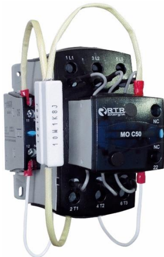
Imagen 2. Contactor RTR Energía con resistencia de descarga rápida 2 \times 1800 \Omega
